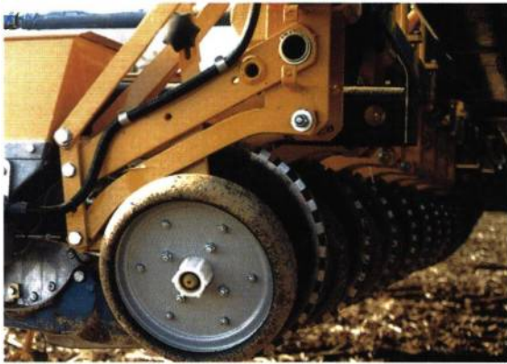
Neu entwickelte gezackte Schneidscheiben bei Sägerät mit Direktsaateinrichtung.
